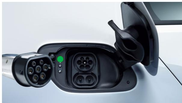
Das Ladekabel kann vom Auto nur entfernt werden, wenn das Auto offen ist. Warten Sie nach dem Öffnen des Autos 2-3 Sekunden. Anschliessend sollte das Kabel mühelos vom Auto entfernt werden können.
